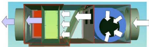
Funktionsschema Deckenventilatorkonvektor Typ VKE
